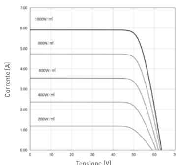
Dati di riferimento per il modello VBHN245J25 [Temperatura della cella: 25°C]
